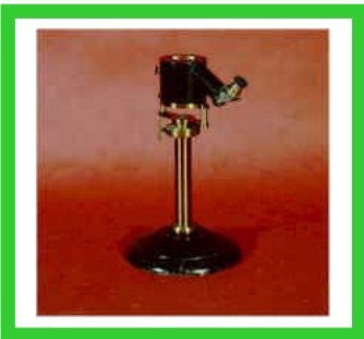
Rifrattometro del 1947 per la misurazione dell'indice di rifrazione dei cristalli.
